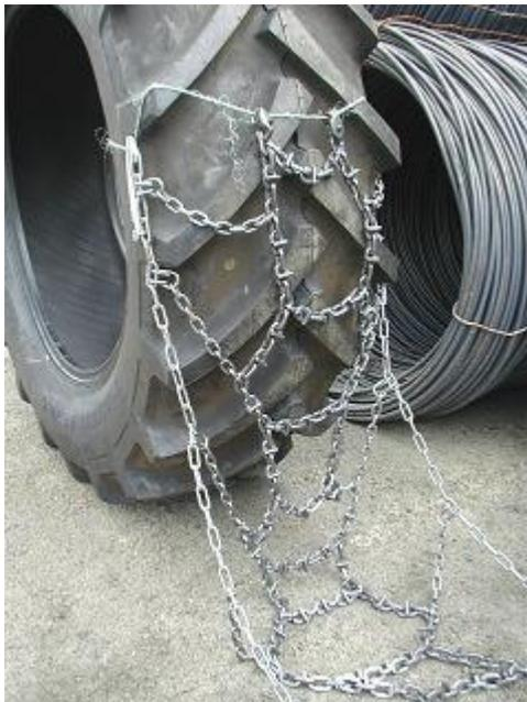
1. Расстелите цепь позади колеса шипованной поверхностью вверх, затяжные рычаги цепи должны находиться напротив шины. На цепях модели TRYGG Superlight требуется сначала собрать боковую цепь. Проще всего устанавливать цепь в зависимости от направления движения колеса.
