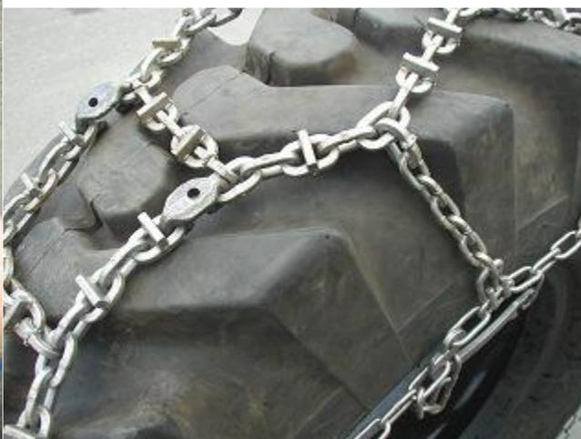
2. Плотно затяните цепь, удалите лишнюю цепь с помощью резака или другого подходящего инструмента. Соедините концы цепи вместе и вставьте шипованный конец цепи в штыревой соединитель. Закрепите штыревой соединитель, полностью вставив штырь в соединителе. Для того, чтобы открыть штыревой соединитель используйте пробойник.
